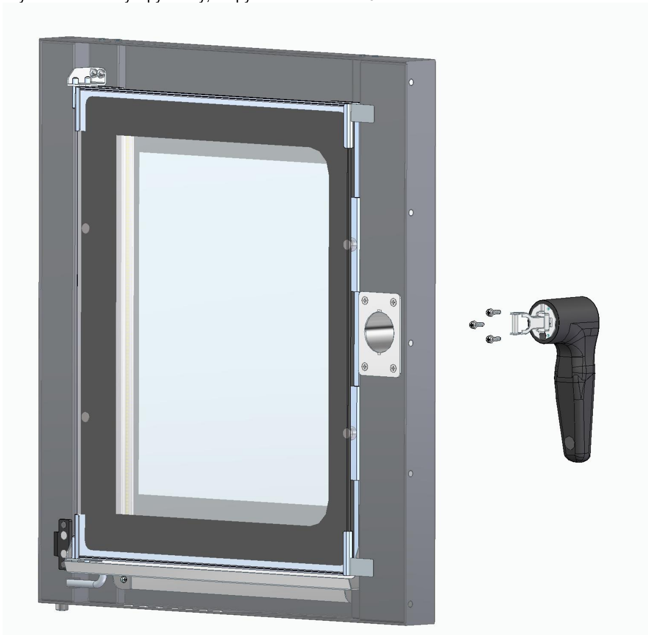
Рис.21 Ремонт замкового устройства
